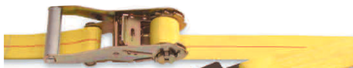
513020 Conjunto Correa de 2 plg con "Ratchet" y gancho plano Largo: 30 pies Carga Límite de Trabajo: 3.335 lb / 1.515 kg
