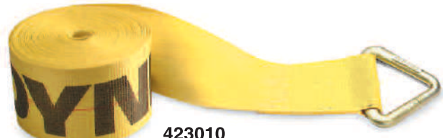
423010 Correa de 4 plg para “Winch” con anillo delta Largo: 30 pies Carga límite de Trabajo: 5.400 lb / 2.455 kg
