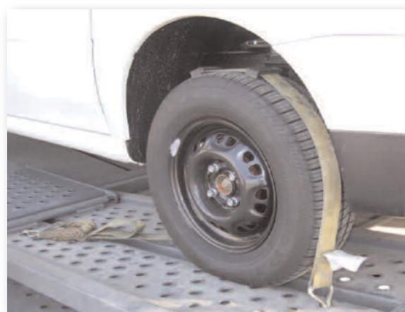
641204 Conjunto Correa de 2 plg con "Ratchet" y gancho de alambre Largo: 12 pies Carga límite de Trabajo: 500 lb / 227,3 kg
